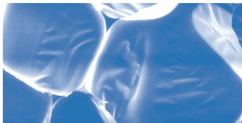
Et naturlig stabilitetsprinsipp: Bildet viser hvordan KAPA® hardskumkjerner i polyuretan ser ut under mikroskopet.
