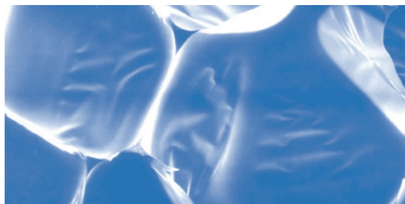
Et naturligt stabilitetsprincip: Billedet viser hvordan KAPA® hårdskumkernen i polyurethan ser ud under mikroskop.
